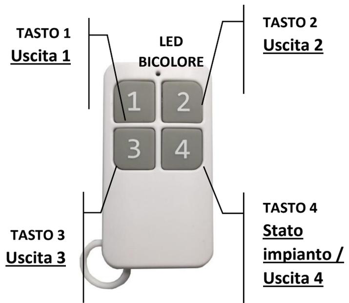
Scegliere la modalità operativa dei telecomandi, e programmare il De Unire, posizionando il Dip1 ON, il Dip2 OFF, Dip3 OFF e Dip4 ON e premere il tasto del radiocomando corrispondente al mode scelto al termine riposizionare i DIP
